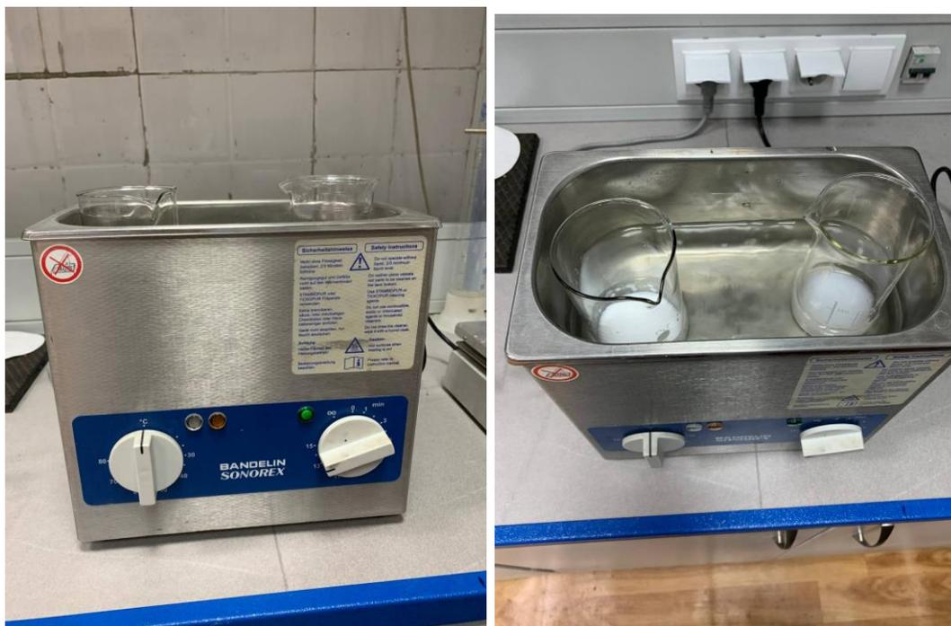
Рисунок 6 – Ультразвуковая обработка образцов
