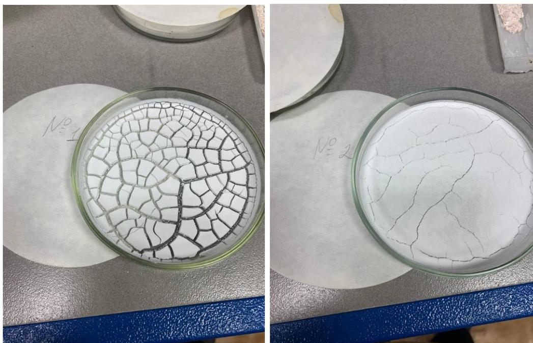
Рисунок 7 – Образцы ГАП после 48 часовой сушки
