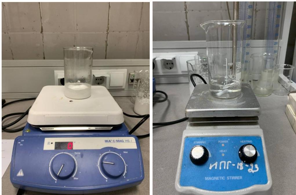
Рисунок 5 – Синтез ГАП: Перемешивание оксида кальция с водным раствором ортофосфорной кислоты на магнитной мешалке
