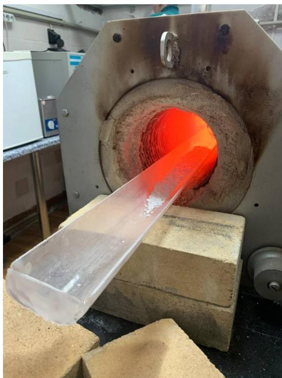
Рисунок 4 – Синтез  $\text{CaO}$ : прокаливание яичной скорлупы в печи
